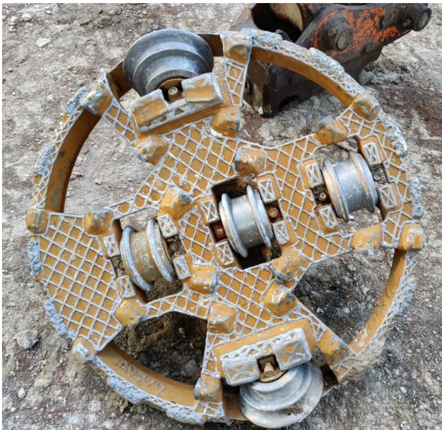
Testa fresante fine perforazione
