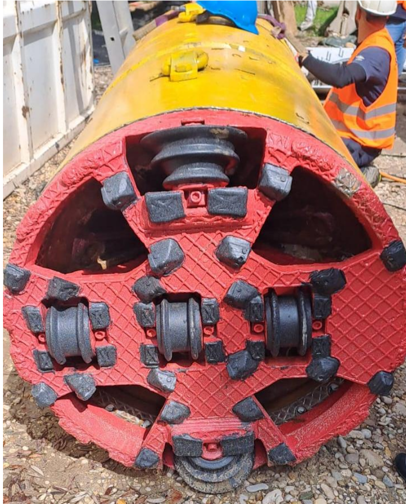
Testa fresante ad inizio perforazione
